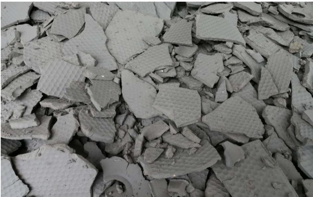
污泥淋滤深度脱水技术实物效果
